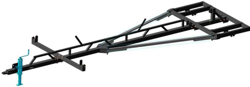
Рисунок 4.5 Дышло с центральной рамой и раскосами.
