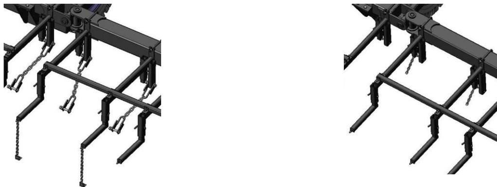
Рисунок 4.9 Крепеж борон к сцепке (слева – зубовых, справа – пружинных)
